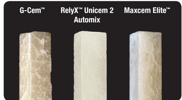
Itsekiinnittyvien muovisementtien lämpörasitustestin tulokset. Testissä kaikkien täytteiden annettiin kovettua itseksensä ilman valoa ja rasisussykli (5-55°C) toistettiin 10,000 kertaa. Lähde: 3M ESPE sisäinen tutkimus
