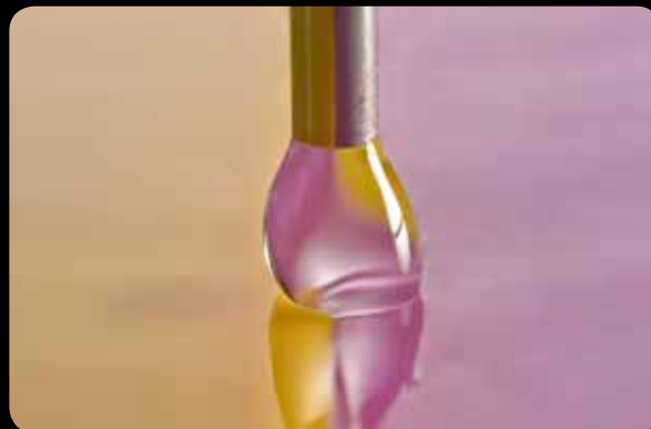
... kahden kovettumattoman A-silikoni jäljennösaineen saumakohtaan (40 sekuntia sekoituksen alusta).
