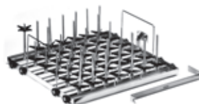
381 555 Mittapullojen pesuteline • 54-paikkainen • vakiomallissa sivureijäilliset suihkuputket: 27 kpl D8, H150 mm ja 27 kpl D6, H100 mm • putket vaihdettavissa
